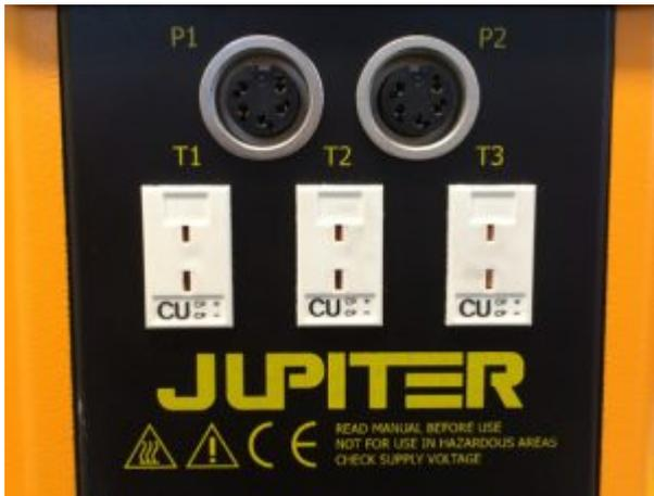
Mit den Advanced Modellen von ISOTECH ist eine echte Vor-Ort-Kalibrierung möglich. Durch die drei Eingänge können neben dem Referenzthermometer zwei Prüflingsfühler angeschlossen und gleichzeitig kalibriert werden. Durch den neuen Regler können alle 3 Eingänge im Display parallel dargestellt werden.
